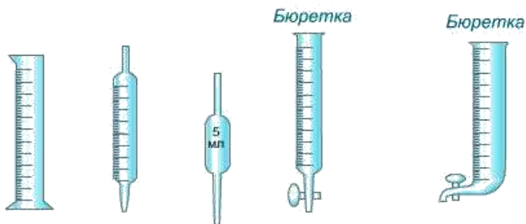
2.5- rasm. O'lchov silindri, pipetkalar va byuretkalar
