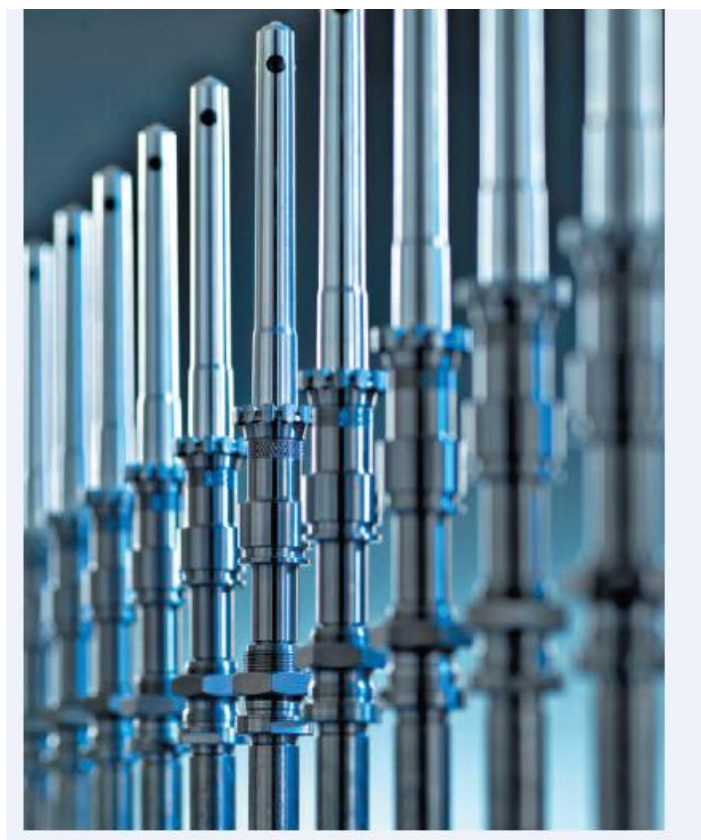
7.7-rasm. Yuqori tezlikda ishlovchi urchuqlar qatori.
