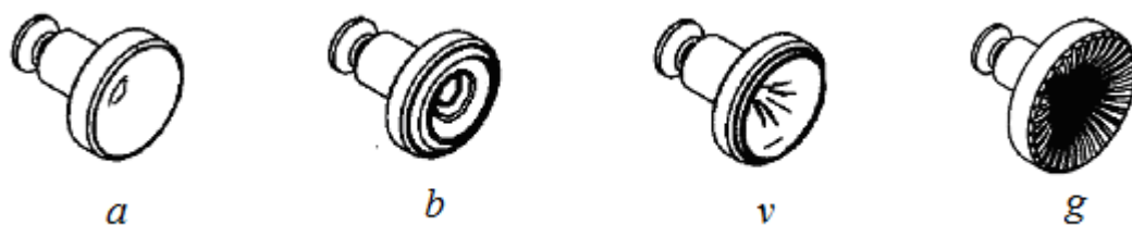
7.9-rasm. Ip o'tuvchi naychalar. a -silliq, b - spirali, v –o'yiqli, g - bo'rtmali.
