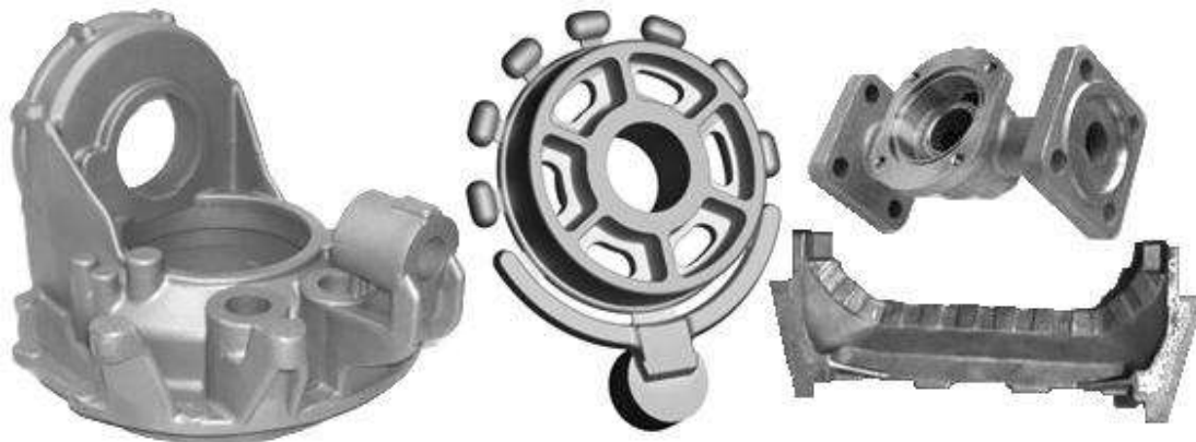
5.16.-rasm. Eruvchi modellar bo'yicha tayyorlangan quymalar.
