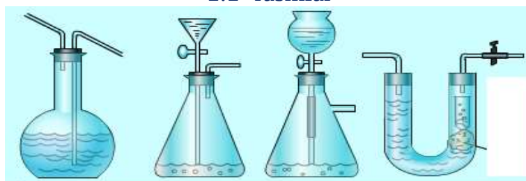
1.2- rasm. Yuvuvchi moslama Oddiy gaz ajratkichlar
