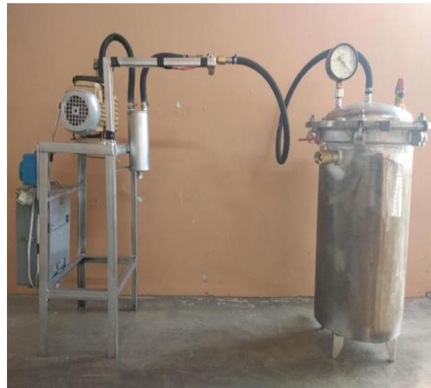
**Рис.10. Общий вид вакуум аппарата для увлажнения шелка-сырца.**
