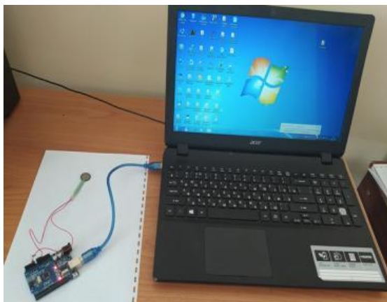
8-расм. ARDIUNO маркали зарба кучини ўлчовчи прибор
