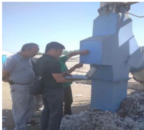
8-расм. ARDIUNO маркали зарба кучини ўлчовчи прибор
