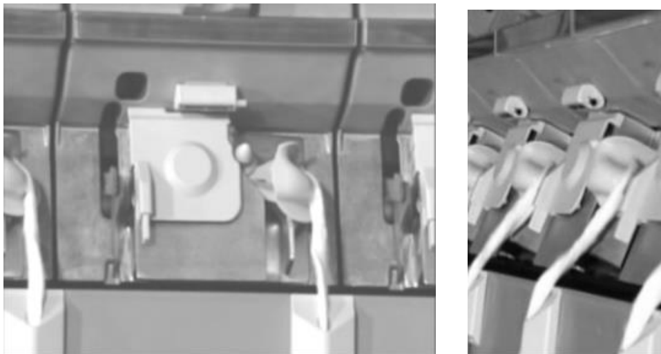
20-расм. Аутокоро тизимидаги пневмомеханик йиғириш машинаси таъминлаш қисмини
