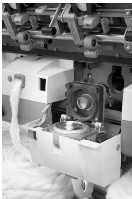
16-расм. C120 русумлиа йигириш қурилмаси ва унинг қисмлари
