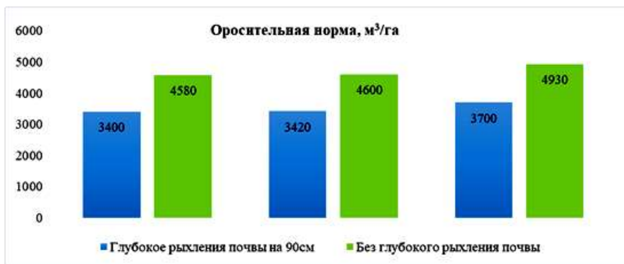
Рис. 2. Изменение оросительных норм при технологии контурного орошения, м³/га
