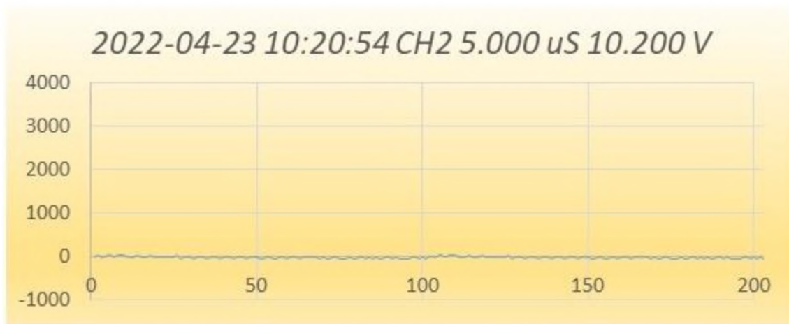
11-расм. Валнинг орқа томонидан олинган индукцион электр юритувчи кучнинг вақт бўйича осциллограммаси
