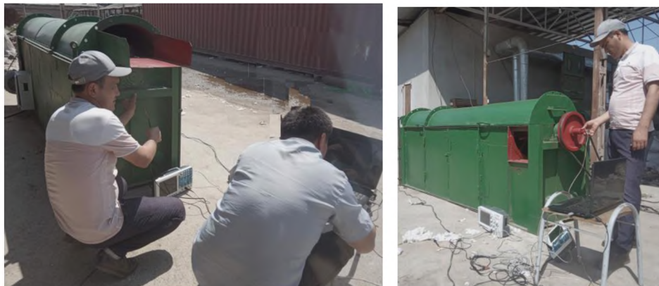
9-расм. Қурилма валидаги ҳаракатини осцилоскоф ёрдамида текшириш
