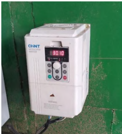
14-расм. Қурилманининг бурчак тезликларини инвектор ва тахометрлар орқали текшириш.
