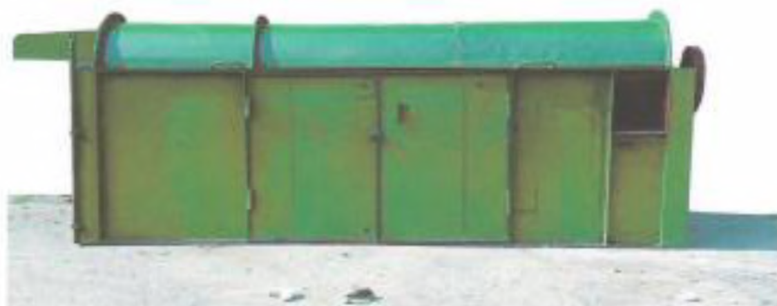
1-расм. УХК пахта тозалаш агрегатида ўриятилган пахтани майда ифлосликлардан тозалаш қурилмаси модернизация қилинган конструкциясининг тажриба нусхаси кўриниши:
