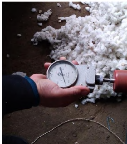
14-расм. Қурилманининг бурчак тезликларини инвектор ва тахометрлар орқали текшириш.
