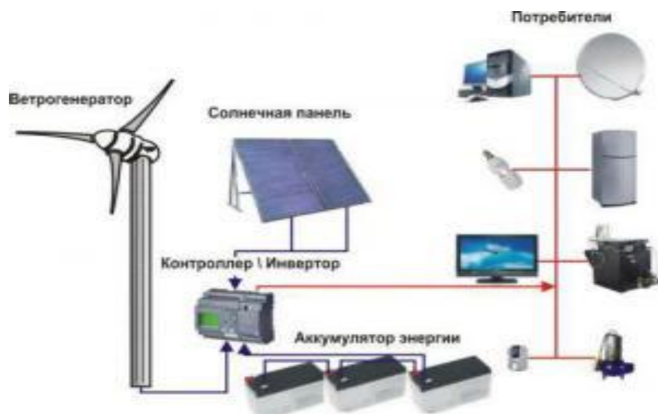
3.4.-Расм. Шамол-куёш Гибрид электр станциясининг намунавий принципиаль структуровий схемаси.
