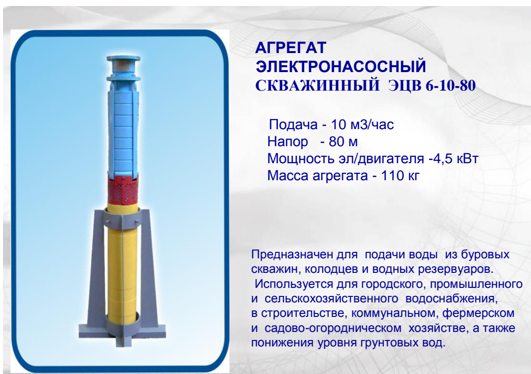
Рис.1.5. Агрегат электронасосный скважинный ЭЦВ 6-10-80
