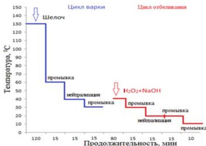
**Рис. 1. Последовательность процесса получения отбеленной целлюлозы из ОСК (а) и температурно-длительный режим проведения процесса (б)**
