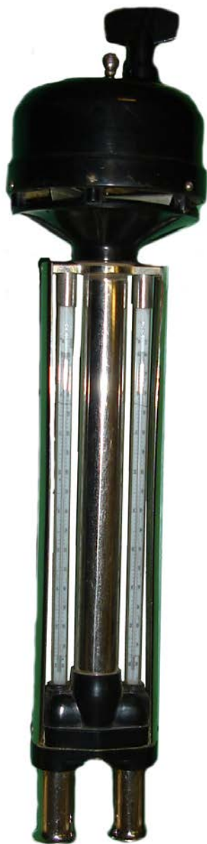
Расм-11. Психрометр асбобининг умумий кўриниши ва термометрлар жойлашиши
