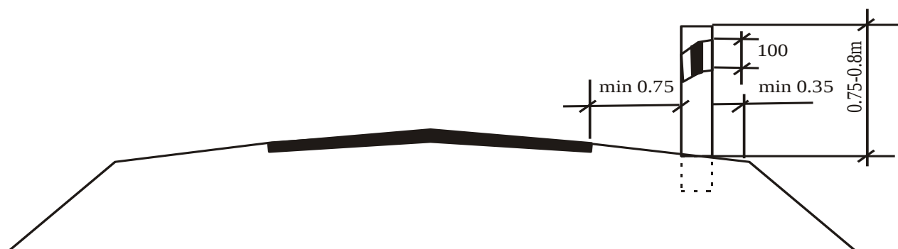
7.14-rasm. Yo'naltiruvchi ustunchalarni yo'lning ko'ndalang kesimida o'rnatish.
