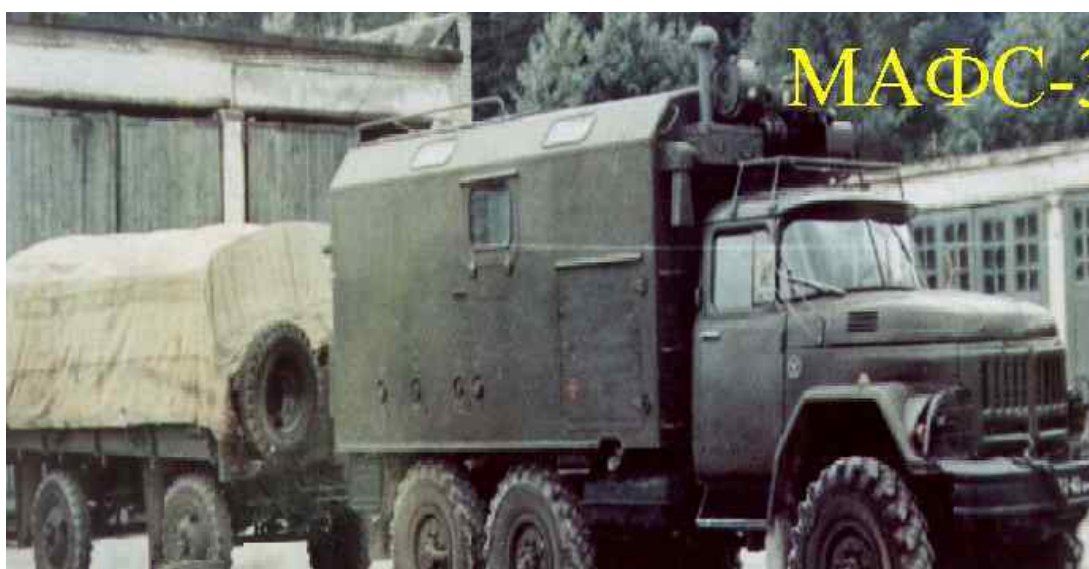
4.2 -rasm. Zamonaviy avtofiltrlash stantsiyasi (MAFS-3).
