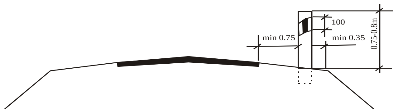
7.14-rasm. Yo'naltiruvchi ustunchalarni yo'lning ko'ndalang kesimida o'rnatish.
