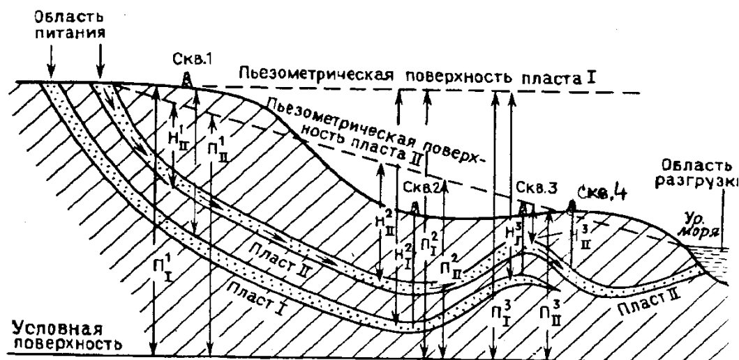
Рисунок 20 – Схема распределения приведенных давлений ( \Pi ) при горизонтальном и наклонном положении пьезометрической поверхности в инфильтрационных системах (по З.А. Табасаранскому; 1982)
