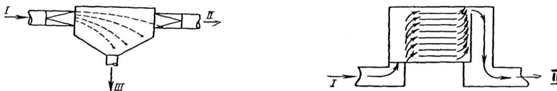
Рис. 6. а - Пылеосадительная камера; б - Осадительная камера Говарда:
