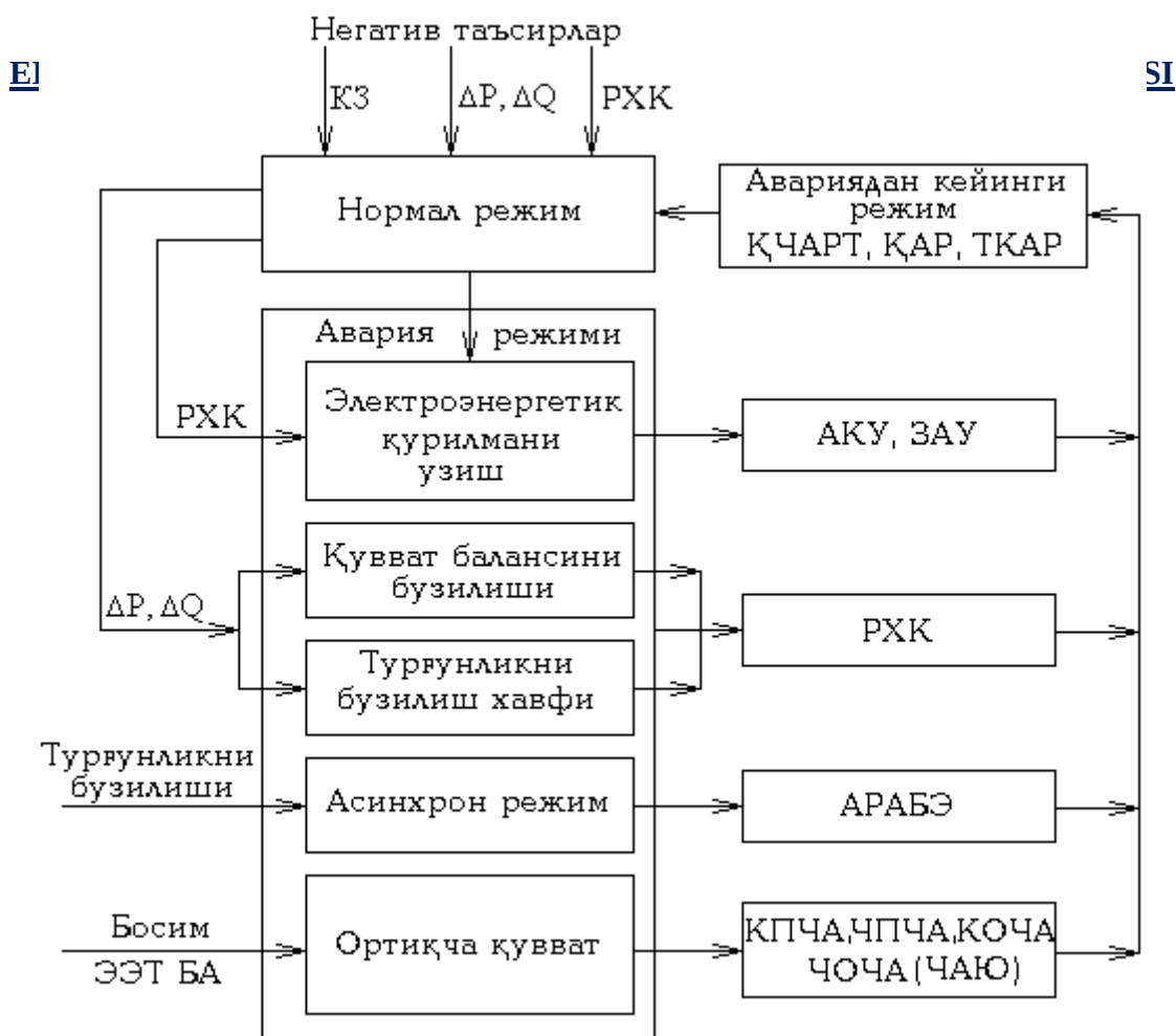
4.8-Rasm. Avariyaqa qarshi avtomatikani funktsional sxemasi.
