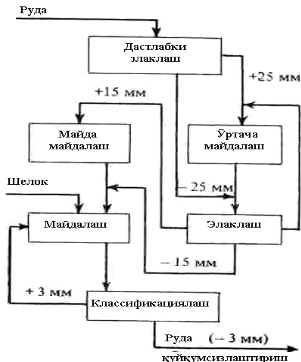
11.1 – rasm. Flotatsiyalashga tayyorlanadigan kaliyli rudani boyitish sxemasi.
