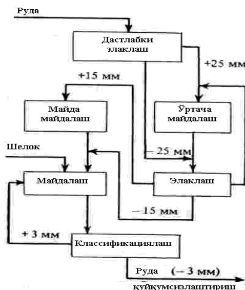
4.1 – rasm. Flotatsiyalashga tayyorlanadigan kaliyli rudani boyitish sxemasi.
