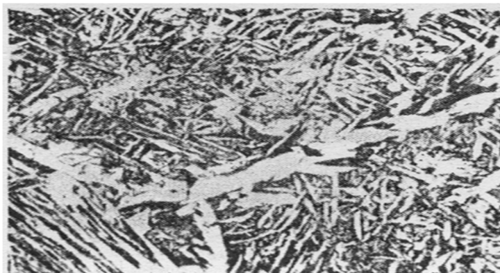
5.3 –rasm. Evtektoidgacha bo'lgan po'lat. Vidmanshtetov strukturasi. X500
