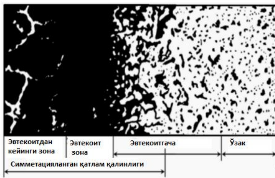
5.8 - rasm. Tsementatsiyalashdan keyin kam uglerodli po'latni mikrostrukturasi X100
