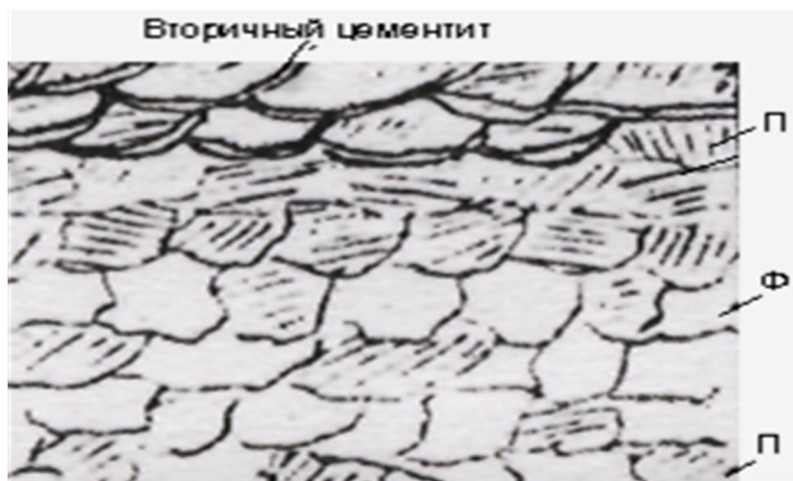
5.9 - rasm. Po'latni tsementatsiyalangan qatlam mikrostrukturasi. X500
