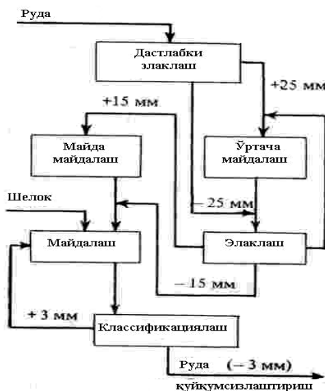
17.1 – rasm. Flotatsiyalashga tayyorlanadigan kaliyli rudani boyitish sxemasi.
