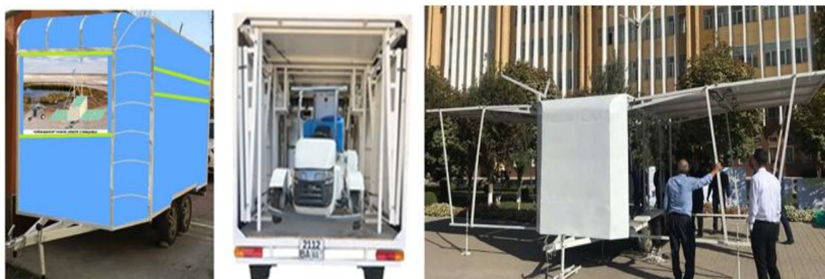
Рис. 8. Транспортное и рабочее положение мобильной электростанции “Солнце-ветер”
