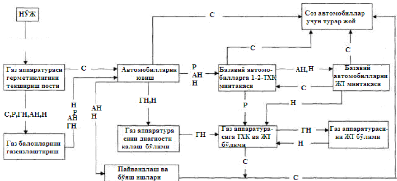
2.1-расм. Газ аппаратурали автқомбилларТХК ва ЖТни технологик шакли:
