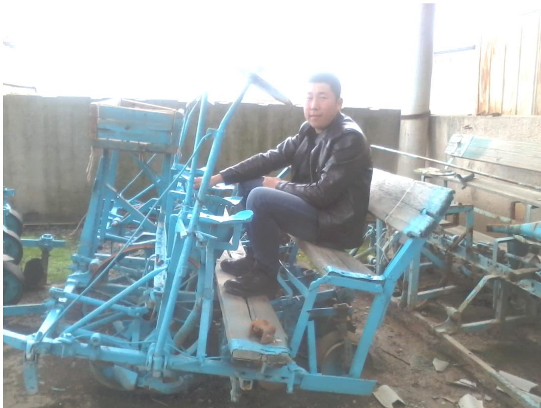
Фото 14.2. Четырех рядковая сеялка монтируемой весной на культиватор.
