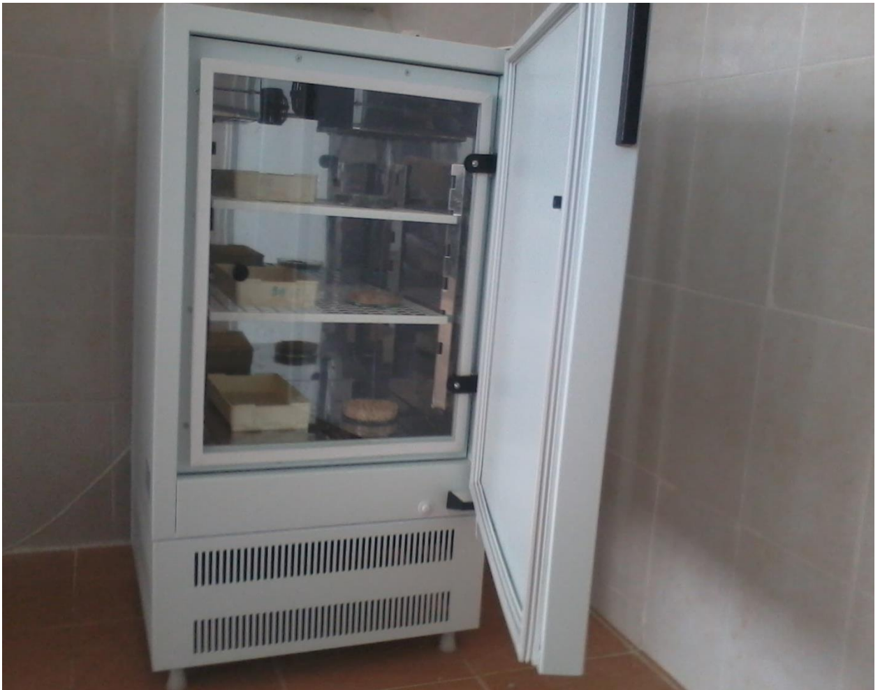
Foto 11. Thermostat zur Analyse der Keimung von Saatgut.
