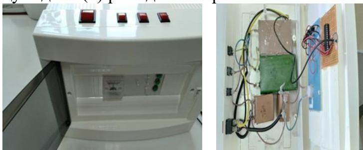
б-расмда фаза роторли асинхрон моторни генератор режимида ишлатишни бошқаришнинг микроконтроллёрли бошқарув блоги ва блокнинг ички тузилиш схемаси кўрсатилган.
