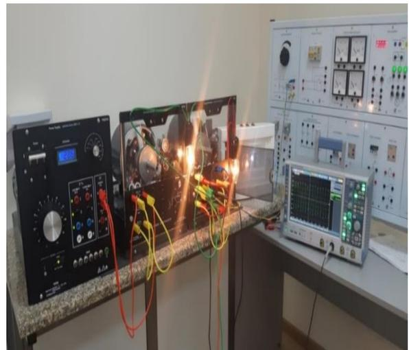
Рисунок 9. Физическая модель для испытания асинхронного генератора с фазным ротором
