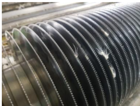
19-rasm. 4DP-130 markali arrali jinlarda puxtalangan tishlari bilan arralarning 72 soat ishlagandan soʻnggi ekspluatatsion holati
