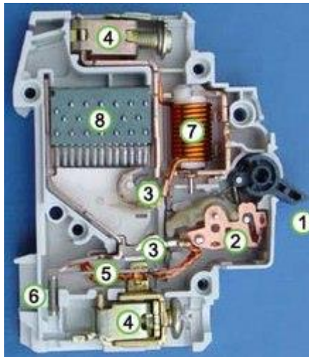
19.-rasm: Avtomatik ishlaydigan himoyalovchi o'chirgich: 1-avtomatik saqlagich; 2-almashtirgichli tugmacha; 3-mexanik haydovchi; 4-kontaktli tizim; 5-ulagichlar; 6-tokni sozlagich vinti(kuchaytirish); elektromagnitli ajratgich; 8-elektr yoyni so'ndiruvchi kamera.
