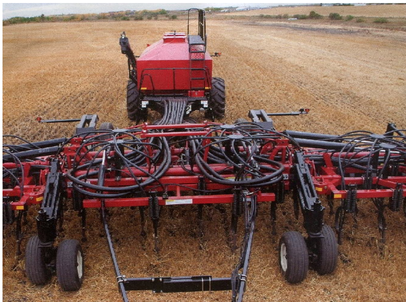
1.32-rasm. YERSATILE DH-750 rusumidagi g'alla ekinlarini ekishga mo'ljallangan pnevmatik seyalka.
