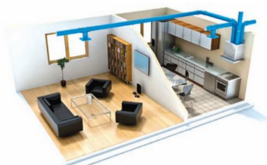
Ovqatlanish xonasi va oshxonada ta'biy ventilyatsiya kanallari
