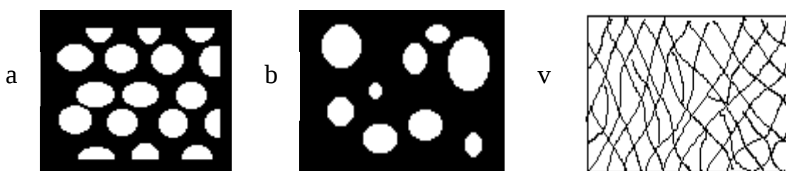
8.12-rasm. Emulsiya turlari: konsentrlangan monodispers emulsiya (a), polidispers emulsiya (b), yuqori konsentrlangan emulsiya (v)
