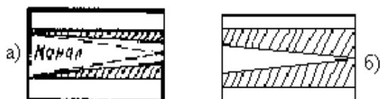
Rasm 59. Maydoniy tranzistorining kanalini kuchlanish ta'sirida torayishi.
