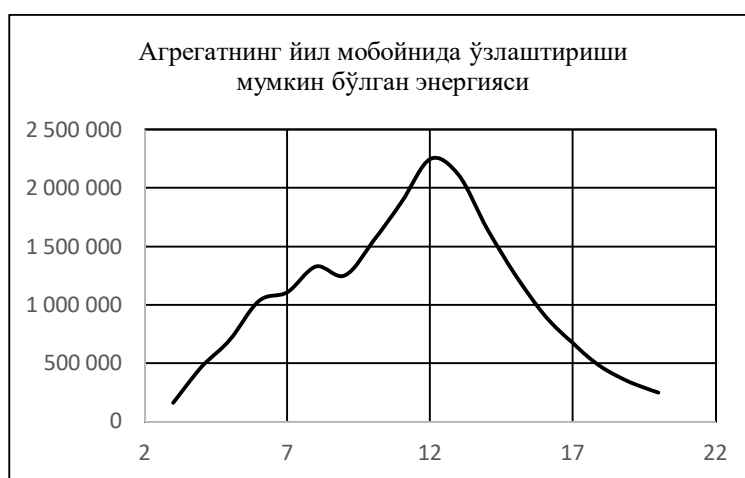
4.3-шакл. Шамол тезлигининг йиллик эсиш соатида 30 м 2 юзадан оқиб ўтувчи энергия миқдори: \eta_{\text{к.п.д. агрегат}} = 0,2
