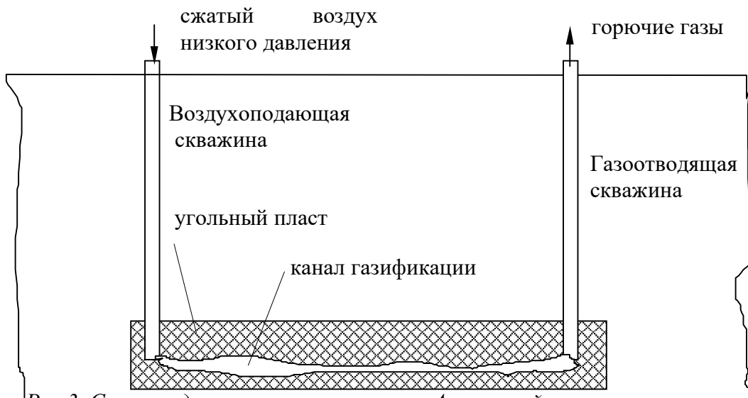
Рис.3. Схема подземного газогенератора Ангренской станции
