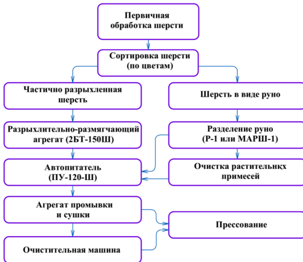
Рис.2. Технологическая схема переработки шерсти
