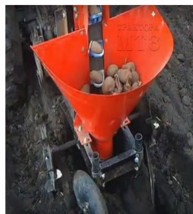
12.5.-rasm. Kartoshka ekish seyalkasining umumiy ko'rinishi va ish jarayoni
