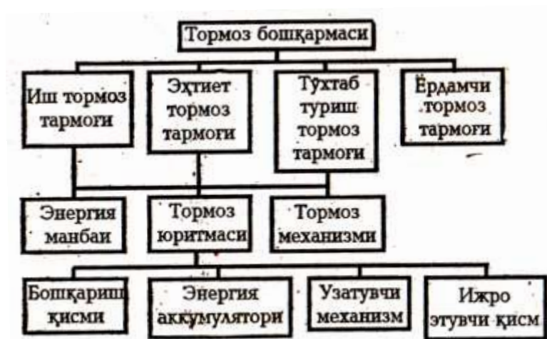
8.1-rasm. Tormoz boshqarmasini muvofiqlashtirilgan tasviriy chizmasi
