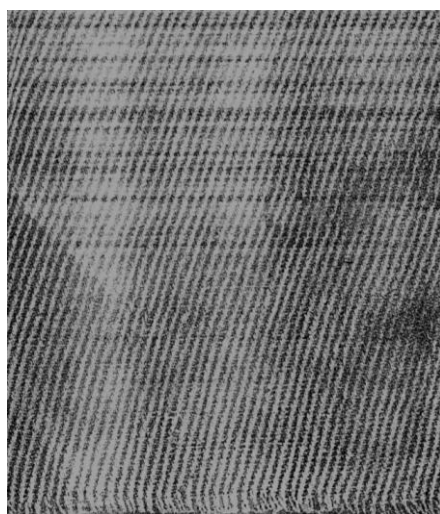
16.6-súwret. Qabıqlar defekti.
