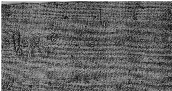
16.7-súwret. Toqıma betindegi halqalar defekti.
