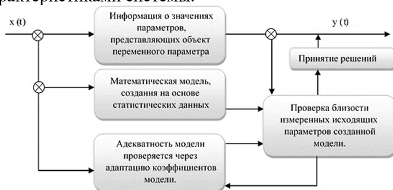
Рис. 2. Схема адаптации математической модели МОП
