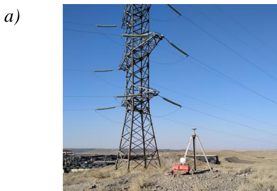
4-rasm. Muruntov geodezik tarmog'ida GNSS o'lchashlarga elektromagnit to'lqin ta'sirini modellashtirish.
