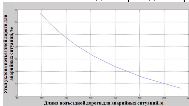
Рис. 4. График зависимости длины аварийного съезда от угла подъема
