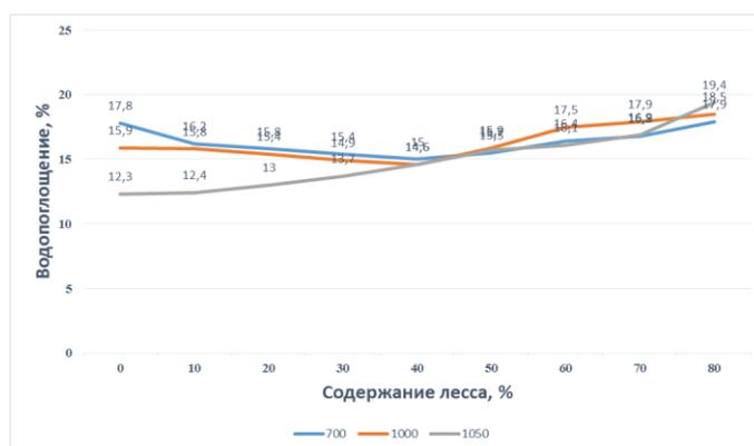
**Рисунок 8. Зависимость водопоглощения кирпича от состава и температуры обжига.**
