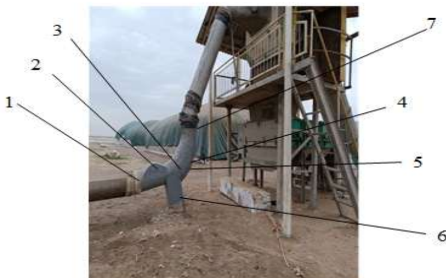
1-kirish quvuri; 2- elastik qoplamali qoziqchali baraban; 3-ishchi kamera; 4-qavariq shaklidagi to'rtli yuz; 5- mayda aralashmalar uchun bo'ylama cho'ntak; 6- og'ir aralashmalar uchun cho'ntak; 7-chiqish quvuri.
