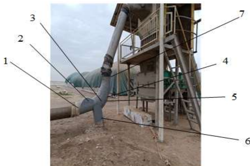
1-входящий потрубок; 2- колковый барабан с эластичным покрытием; 3- рабочая камера; 4-сетчатая поверхность выпуклой формы; 5- продольный карман для мелких примесей; 6- карман для тяжелых примесей; 7-выходной потрубок.
