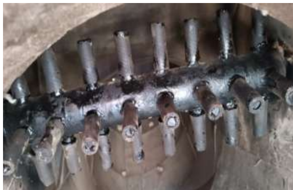
17-rasm. Toshtutgich qurilmasining kirish quvuriga oʻrnatilgan elastik qoplamali qoziqchali baraban.
