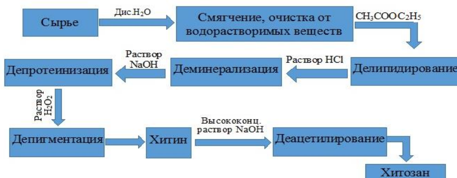
Рисунок 1. Процесс экстракции хитозана
