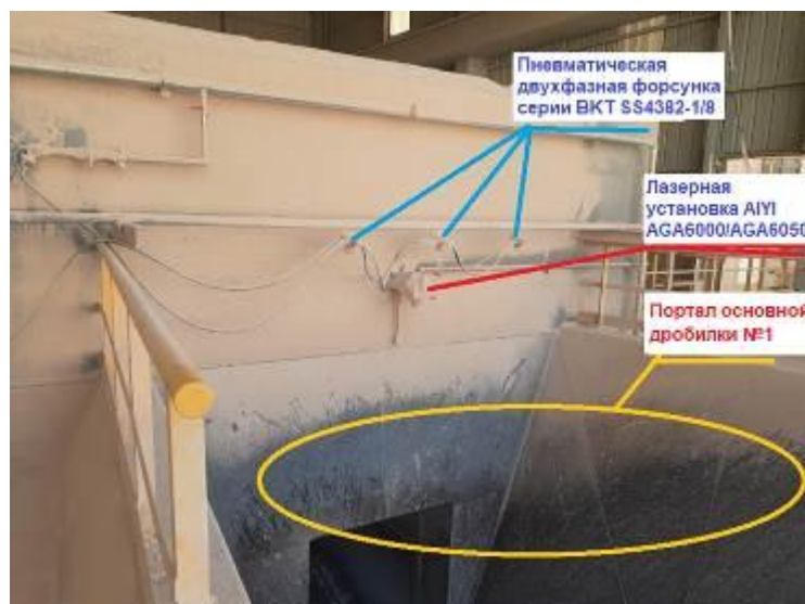
Рис. 9. Портал приема известняка в дробилку при эксперименте
