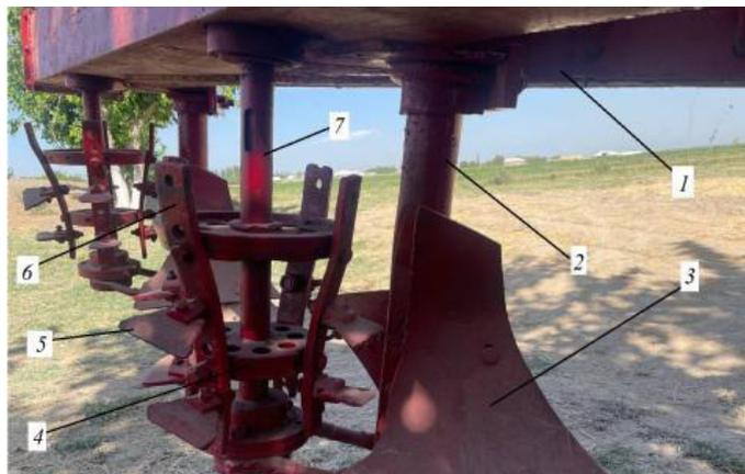
**Рис. 7. Расположение корпуса плуга с комбинированными рабочими органами**
