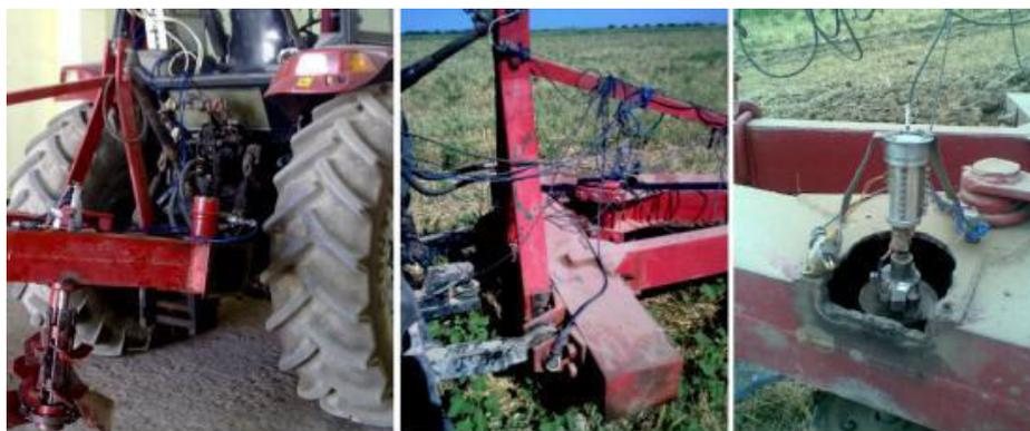
**Рис. 8. Отдельные виды тензометрического плуга**
