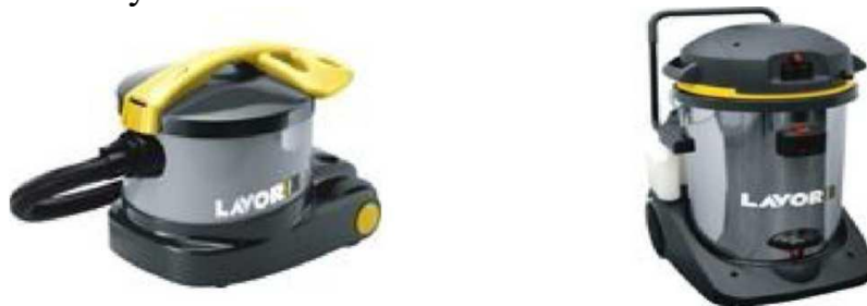
2-rasm. Qo'chma va qo'zg'almas changyutgich turlari (Lavor firmasi), quvvati 1500 vatt, so'rish qobiliyati 3190 mm suv ustuni, havo oqimi 140 m/soat.
