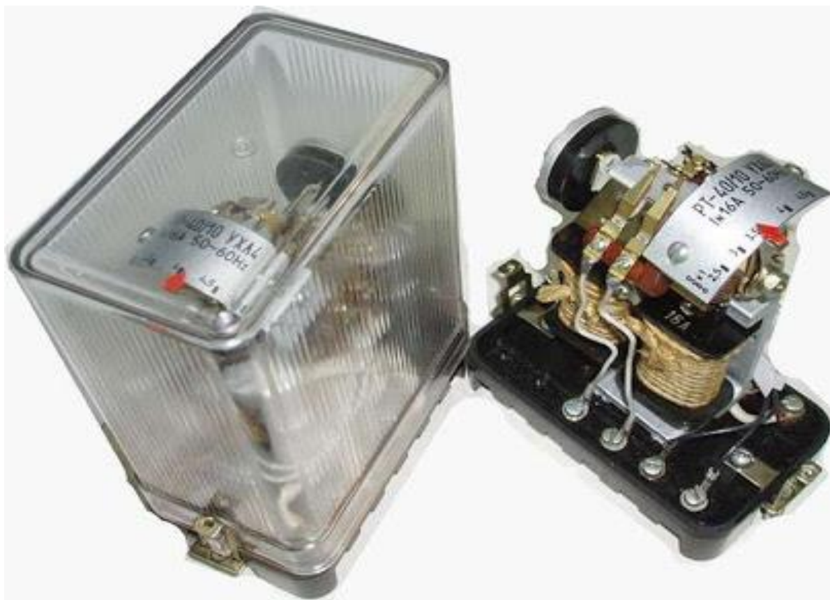
5.2.4-Расм. PT-40 русумли ток релесининг умумий кўриниши
